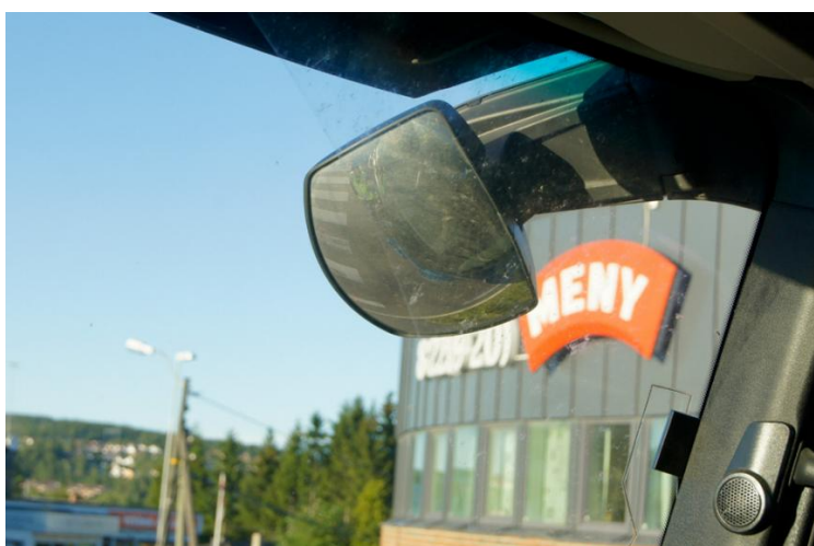
Figur 5 Skittent speil lastebil med fotgjenger med refleks-vest, er så vidt synlig for et årvåkent blikk uten stress eller samtidigetskonflikter i trafikken. Sterkt sollys vil forsterke dette problemet (Jan Holst, UAG, Statens Vegvesen).
